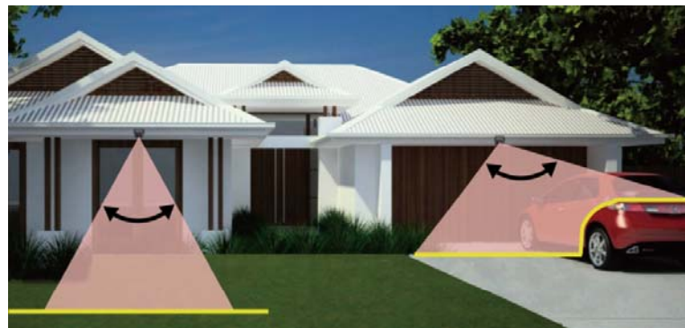
單一攝影機搭載光源, 透過光源圖樣變化分辨物體, 降低傳統影像辨識誤判率
